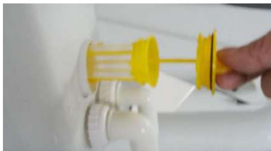
Deschideți consola și găsiți filtrul
