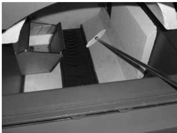
Transferul cenușii, peste grătar, în spațiul (cenușarul) inferior
