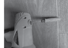
Замена угольных (графитовых) щеток
