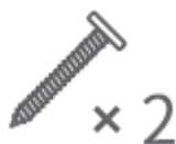
Samořezný šroub Rozměry: M4 x 40 mm
